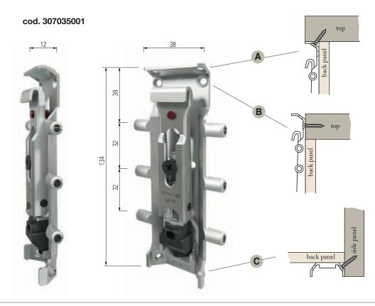
Nella progettazione di Sikura sono stati previsti più punti di fissaggio atti a rinforzare l'unione dell' attaccaglia al mobile. Le tipologie di applicazione sono principalmente di tipo A per mobile con Top di finitura e tipo B con Top filo schiena. Nella parte inferiore di Sikura sono invece previste due alette per il fissaggio al fianco Dx o Sx (vedi schema C).
